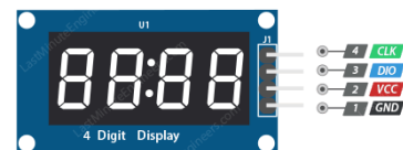
TM1637 Module Pinout
