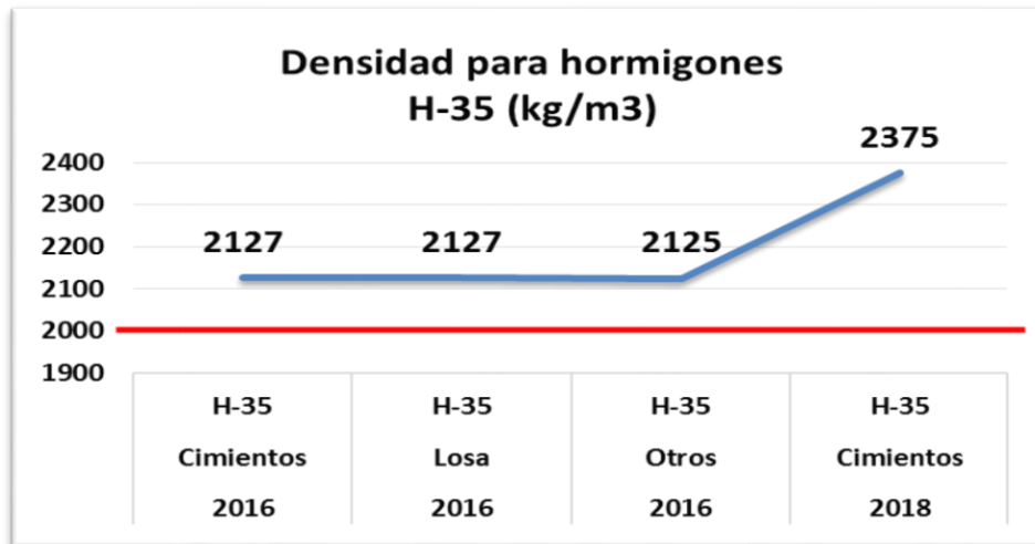
FIGURA No.7C: VALORES DE RESISTENCIAS A COMPRESIÓN, DENSIDADES Y POROSIDADES EFECTIVAS, ALCANZADOS EN EL PERIODO, EN HORMIGONES H-35. (FUENTE: ELABORACIÓN PROPIA)
