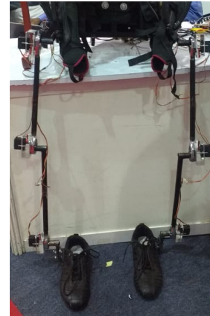
Fig. 2. Lower Body Exoskeleton Actual Model
