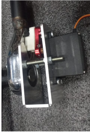
Fig. 4. Two way ratchet assembly actual model
